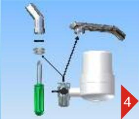
4 Je nach Gewindetyp ggf. Adapter incl. Dichtung einsetzen, leicht festziehen (mit Inbus12 oder Schraubendreher 11..13 mm breit).
