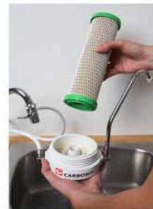
5. An den Enden der neuen Filterpatrone befinden sich grüne Kappen. Eine der beiden Kappen ist mit einem Austrittsloch versehen. Die direkt auf der Kappe sitzende Flachdichtung entfernen Sie bitte. Sie wird für den Einsatz der Filterpatrone in Ihrem Filtersystem nicht benötigt.
