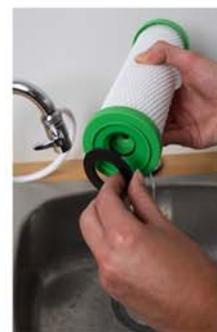
6. Um die neue Filterpatrone einzusetzen, wird das Filtergehäuse auf den Kopf gestellt. Stellen Sie die neue Filterpatrone so in das Filtergehäuse, dass die grüne Kappe mit Austrittsloch zu sehen ist. Achten Sie darauf, dass der große Dichtring in der Filtertasse korrekt in dem dafür vorgesehenen Rand liegt und schrauben Sie das Filtergehäuse handfest zu.
