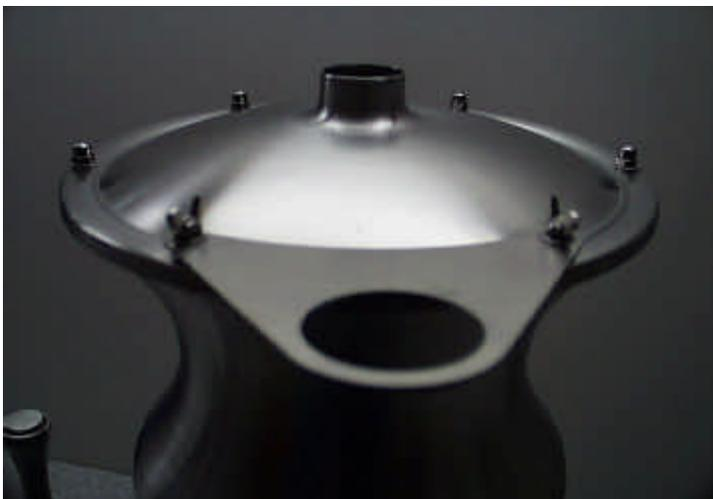
Angeschraubtes Blech zur Ablage des Deckelverschlusses
