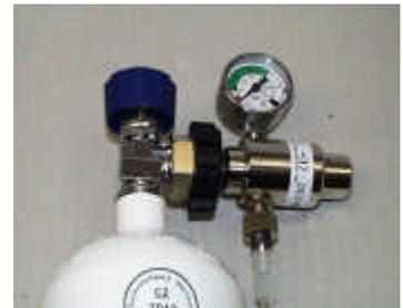
Schrauben Sie den Druckminderer auf den Schlauch auf.
