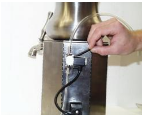
Montage des Magnetventils an der Leva Quell - Anlage
